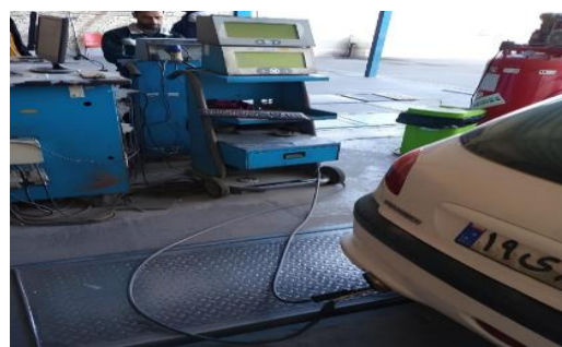
شکل (۲): نحوه قرارگیری پروب دستگاه آنالیزور دود (پنج‌گاز) در آگزوز خودرو در حالت درجا
