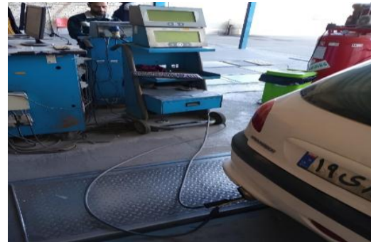
شکل (۲): نحوه قرارگیری پروب دستگاه آنالیزور دود (پنج‌گاز) در آگزوز خودرو در حالت درجا
