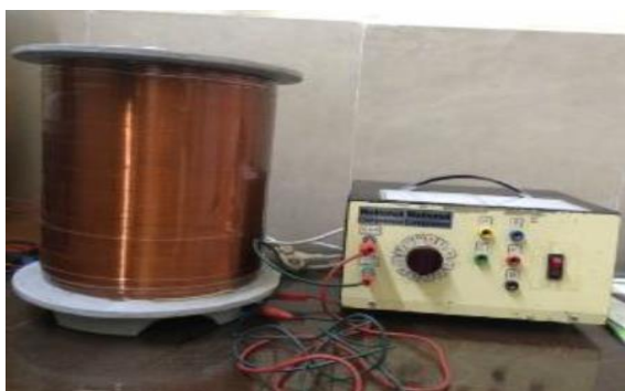
شکل ۱: منبع تولید امواج الکترومغناطیسی، دستگاه Helmholtz coils
