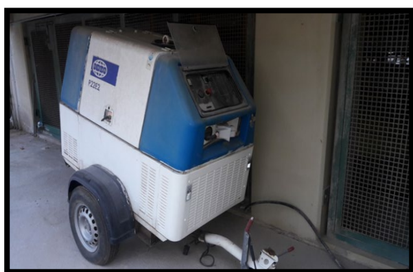
شکل (۱۳): دیزل ژنراتور ۲۵ کیلو ولت آمپر استفاده شده در آزمایش تست بار مقاومتی
