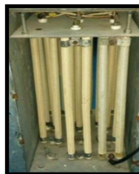
شکل (۱۱): بانک بار مقاومتی ساخته شده
