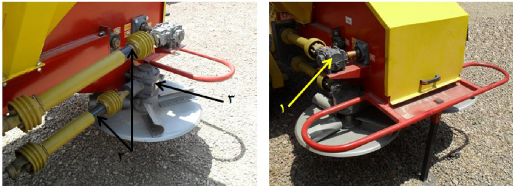
شکل ۳- سیستم انتقال توان: ۱) گیربکس زنجیرنقاله، ۲) میل‌گاردان، ۳) گیربکس حلزونی صفحه کودپران
