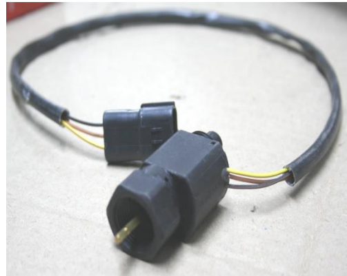
شکل ۷- حسگر سرعت خودرو VSS و طریقه اتصال آن به ECU (Ibid)
