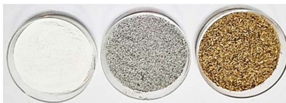
الف ب ج شکل ۲ طرح‌واره کلی از مراحل سنتز: RHs خرد شده (الف)، کلسینه شده (ب) و نانوذره‌های \text{SiO}_2 آریخت (ج)
