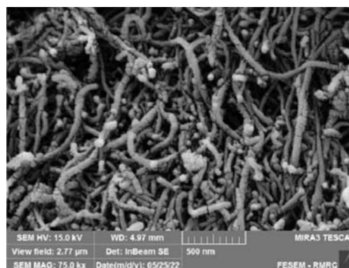
شکل ۳ تصویر SEM نانوجندسازه مغناطیسی Cu/Fe 3 O 4 @MWCNTs
