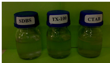
شکل ۵ امولسیون تشکیل شده از گاما آلومینای سنتز شده، با سورفکتانت‌های متفاوت (نام سورفکتانت مورد استفاده بر روی ظرف نمونه مشخص شده است).
