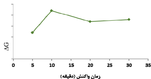
شکل ۴ اثر زمان واکنش در مقدار خاموش سازی شدت فلورسانس رودامین B در حضور یدید (شرایط آزمایش: رودامین B، ۱ میلی لیتر با غلظت 10^{-5} \times 3/1 مول بر لیتر و سایر شرایط آزمایش همانند شرایط بیان شده در شکل ۳ است.)
