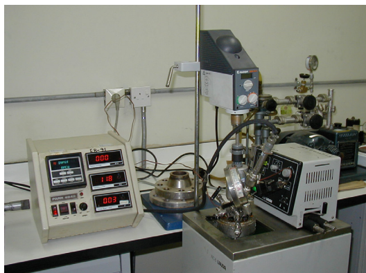
شکل ۱ واکنشگاه PARR و اتاقک واپایش مدل ۴۸۴۲ با سیرکولاتور LAUDA مدل RC6 با سامانه واپایش LAUDA مدل RCS برای انجام مطالعه‌های هیدرات‌های گازی
