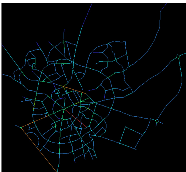
شکل ۶. بررسی شاخص اتصال در محورهای شهر همدان Figure 6. Examining the connectivity index on the axes of Hamedan city
