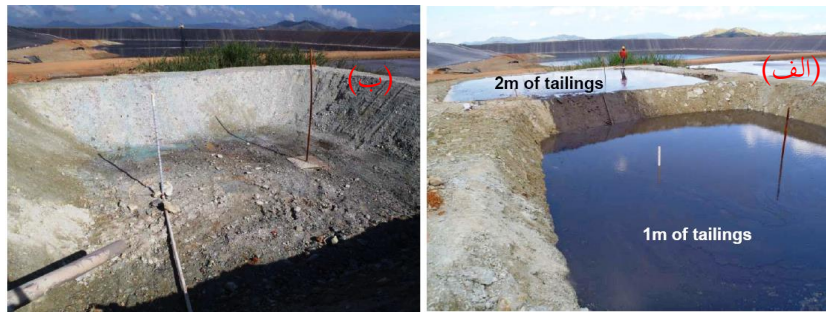
شکل ۱۷- سلول‌های آزمایش الف) قبل از ریختن باطله فرآوری ب) بعد از ریختن باطله فرآوری (۲۸)
