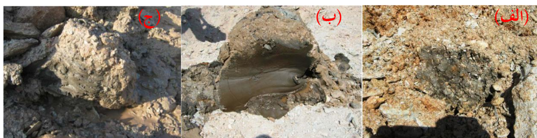
شکل ۱۵- سطح مشترک سنگ باطله و باطله فرآوری در استراتژی‌های الف) اول، ب) دوم و ج) سوم (۲۸)
