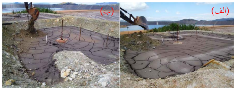
شکل ۱۹- قرار دادن لایه سنگ باطله PAG در سلول الف) با عمق یک متر باطله فرآوری ب) با عمق دو متر باطله فرآوری
