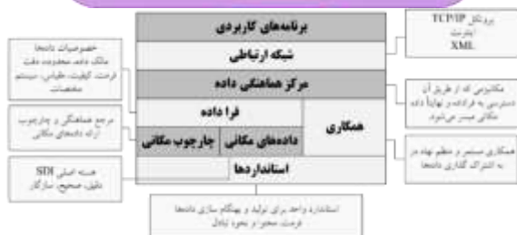
شکل ۲- اجزاء زیرساخت داده مکانی و روابط میان آن‌ها منبع: (سرور و همکاران، ۱۴۰۲)
