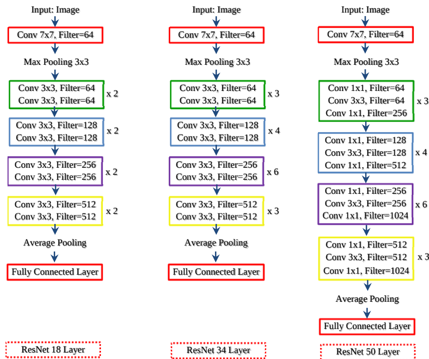
شکل ۵. ساختار مدل‌های یادگیری عمیق باقیمانده با ۱۸، ۳۴ و ۵۰ لایه
