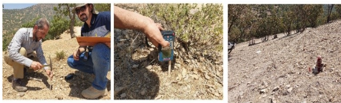
شکل ۲. اندازه گیری میدانی فرسایش و رسوب به کمک پیکه های فرسایشی در جاده جنگلی کهیان Fig 2. Field measurement of erosion and sedimentation using markers in the forest road area of Kohian
