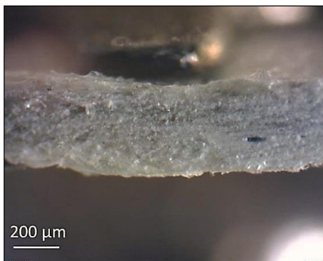
شکل ۳- تصویر مقطع گسکت میکایی در بزرگنماییهای مختلف.
