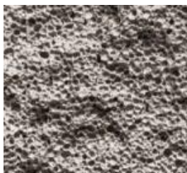
شکل ۵: ساختار متخلخل بتن هوادار (Ahmed & Kamau, 2017)
