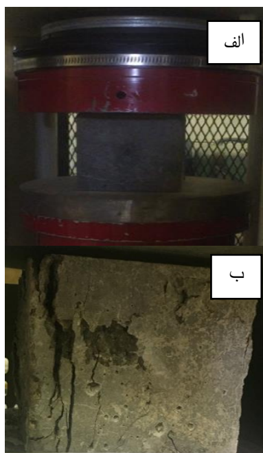
شکل ۵-الف) دستگاه مقاومت فشاری (ب) شکسته شدن بتن پس از اعمال فشار
