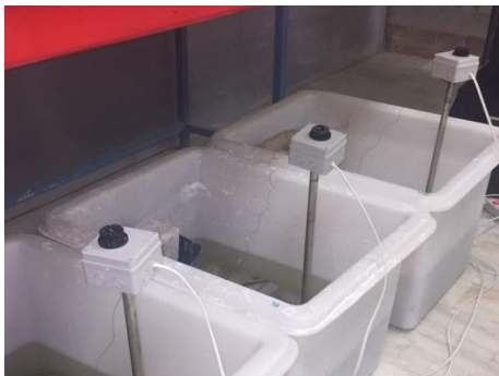
شکل ۲- تنظیم دمای هر مخزن به وسیله هیتر و ترموستات
