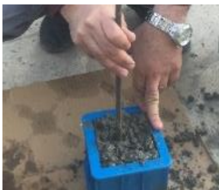
شکل ۳- ریختن و متراکم کردن بتن ساخته شده در قالب مکعبی
