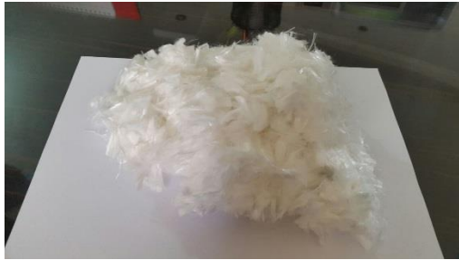
شکل ۲- الیاف پلی پروپیلین مصرفی
