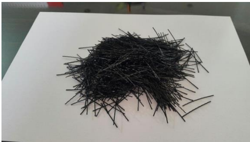
شکل ۳- الیاف پلی الفین مصرفی
