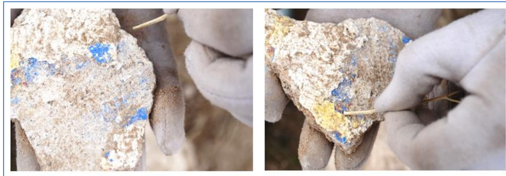
تصویر ۱۰- نمونه برداری از رنگ دانه های موجود بر سطوح گچی بدست آمده از کاوش مسجد سنگ‌بست (منبع: نگارندگان، ۱۳۹۶)
