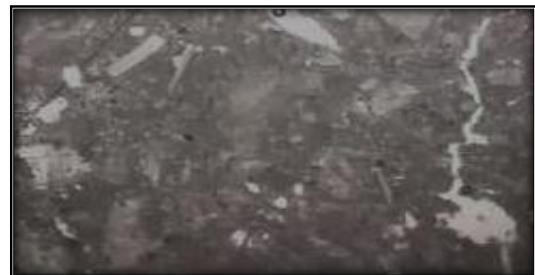
شکل (۱۳): تخلخل حاصل از شکستگی به همراه تخلخل حفره‌ای
