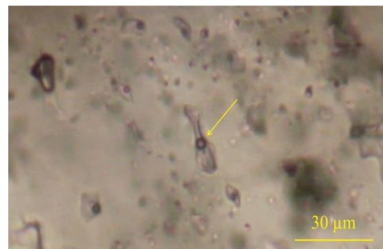
شکل (۵): باریک شدگی (necking down) در میانبارهای سیال دوفازی غنی از مایع (L+V) در نمونه‌های باریت کانسار آب ترش.
