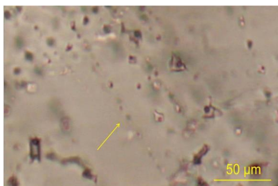
شکل (۳): میانبرهای سیال ثانویه در روندهای خطی در نمونه‌های باریت کانسار آب ترش.
