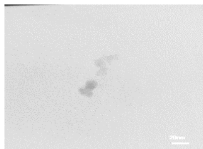
شکل الف) نانوذره سولفات نئومایسین با ابعاد ۲۰nm و بزرگنمایی ۸۰۰ هزار برابر
