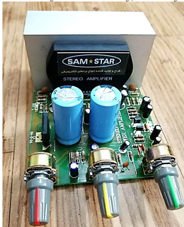
شکل (۱۸): تقویت کننده صوتی کلاس AB برای تقویت سیگنال اعمالی به هسته تحت تست Figure (18): Class AB Amplifier for amplifying the applied signal to the core under test
