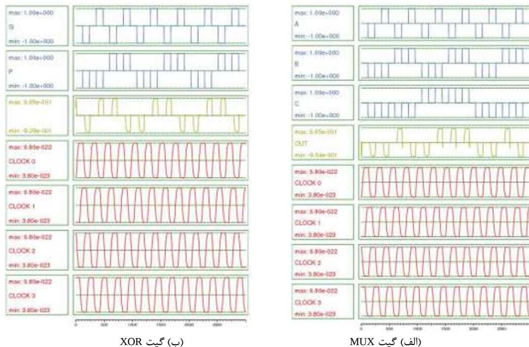
شکل (۱۶): نتیجه شبیه سازی گیت های پایه به کمک آتوماتای سلولی نقطه کوانتومی- ورودی انتشارگیت پیشنهادی Figure (16): The result of the simulation of basic gates using the proposed QCA-GDI, a) MUX gate, b) XOR gate
