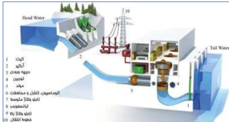
شکل (۱): ساختار نیروگاه برق-آبی [۲۰]
