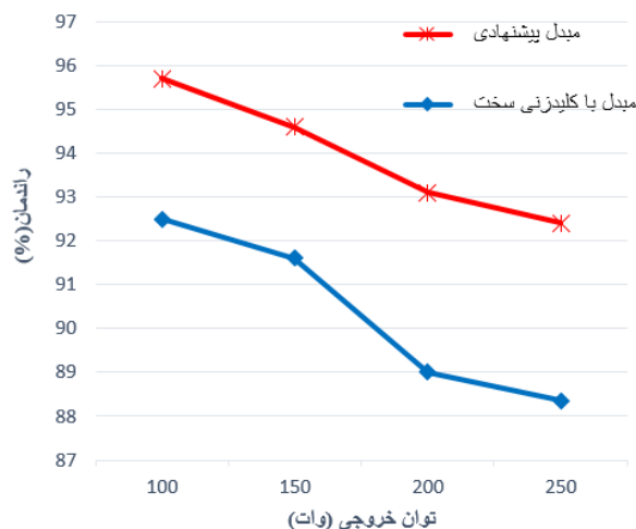
شکل (۹): نمودار راندمان مبدل پیشنهادی در مقایسه با نمونه کلیدزنی سخت آن Figure (9): Efficiency graph of the proposed converter in comparison with the hard switching counterpart
