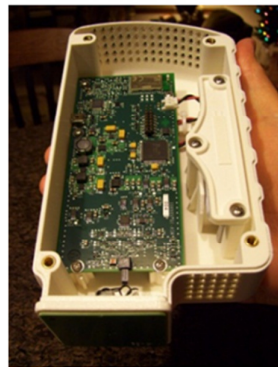
شکل (۱۲): سیستم مقطع‌نگاری القای مغناطیسی همراه سیم‌پیچ اسکن کننده محیط شی هدف [۵۵]. Fig. (12): The magnetic induction tomography system and its imaging object scanner [55].
