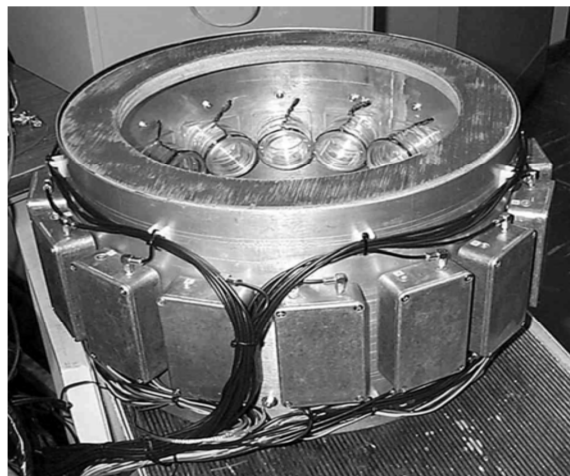
شکل (۵): سیستم مقطع‌نگاری القای مغناطیسی ۱۶ کاناله حساس به فاز [۷].
