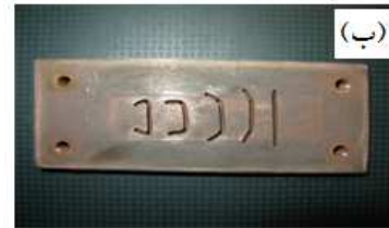
شکل (۱): (الف) طرح شماتیک و (ب) تصویر قالب فولادی تهیه شده برای شکل دادن نمونه‌ها
