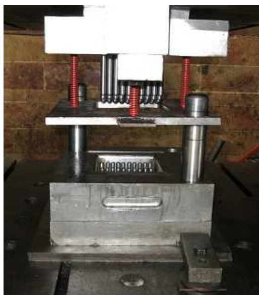
شکل (۵): مجموعه قالب شکل‌دهی چند نقطه‌ای در حالت نصب بر روی دستگاه پرس.
