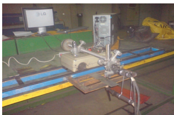
شکل (۶): بازوی مکانیکی جوشکاری قوسی تنگستن-گاز
