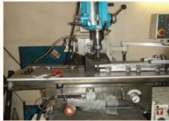
شکل (۲): فرزند مورد استفاده برای آزمایش FSP
