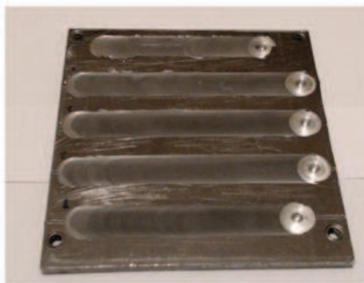
شکل (۳): نمونه کامپوزیت ایجاد شده توسط فرآیند اصطکاکی اغتشاشی
