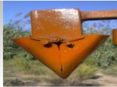
شکل ۱- نمونه‌ای از نشاءگیر مخروطی طراحی شده
