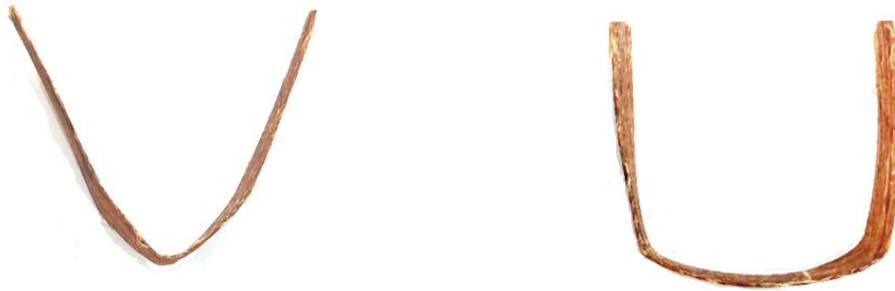
شکل ۱۰- مدل نهایی خمکاری شده توسط قالب‌های مختلف (راست: U-Shape چپ: V-Shape)
