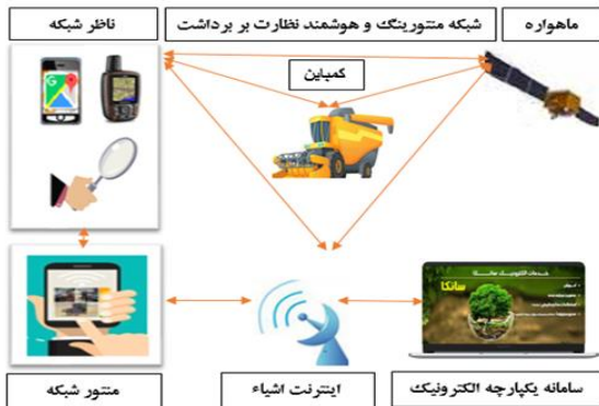
شکل ۲- ابعاد مختلف شبکه منتورینگ و نظارت هوشمند بر ماشین‌های برداشت
