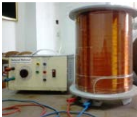
شکل ۱- دستگاه تولید میدان الکترومغناطیسی که واجد یک ژنراتور و یک سیم پیچ می باشد.
