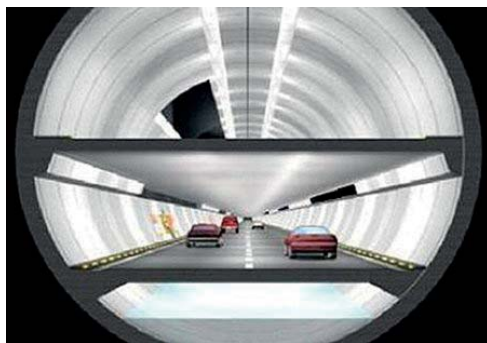
شکل ۳: مقطع عرضی از تونل پروژه SMART
