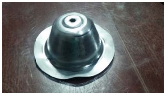
شکل ۶ نمونه شکل دهی ورق در تست سوم
