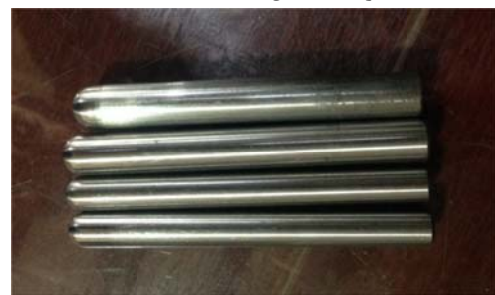
شکل ۳ نمونه های ساخته شده ابزار شکل دهی
