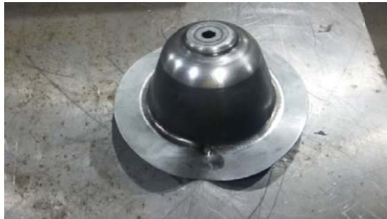
شکل ۴ نمونه شکل دهی ورق در تست اول
