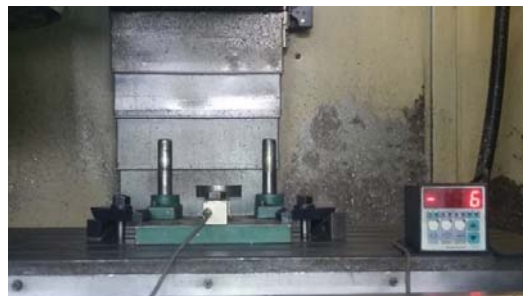
شکل ۷ نمای مونتاژ شده ی لودسل بر روی دستگاه CNC
