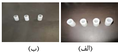
شکل ۳- الف) سابوت ساخته شده (ب) نحوه قرار گرفتن پرتابه در سابوت
