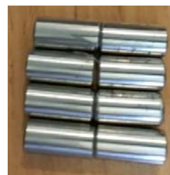
شکل ۱- پرتابه استفاده شده در این آزمایش
