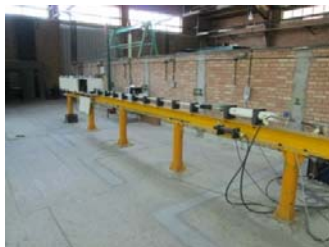
شکل ۵- تفنگ گازی استفاده شده مستقر در آزمایشگاه
