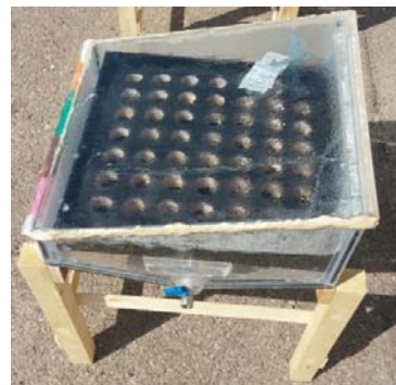
شکل ۳ نحوه قرارگیری اسفنج درون مخزن آب شور
