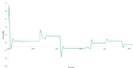
شکل-۱۰ تاریخچه زمانی نیروی وارد شده به چرخ عقب خودرو در اثر مانور شتاب گیری در طول مسیر حرکت
