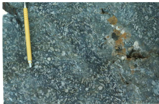
شکل ۴- سنگ میزبان آندزیتی با فنوکریست‌های درشت پلاژیوکلاز
