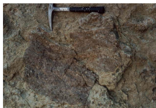
شکل ۱۹- کانه‌زایی در اطراف کلاست‌ها در زنگالو
