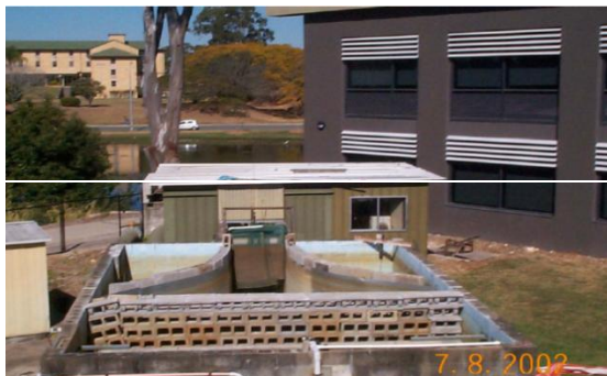
شکل 7: مخزن و تنگ شدگی ورودی و صاف کننده جریان
