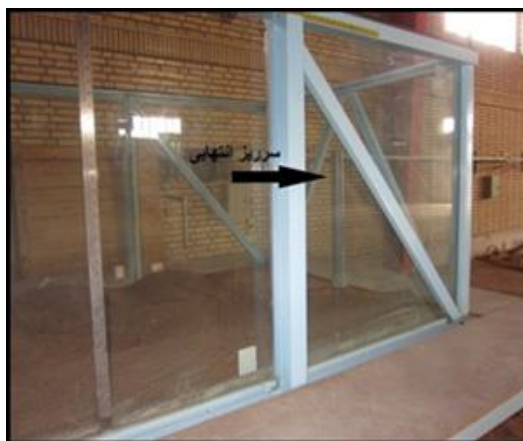
شکل ۴: سرریز انتهایی فلوم در حال کار
