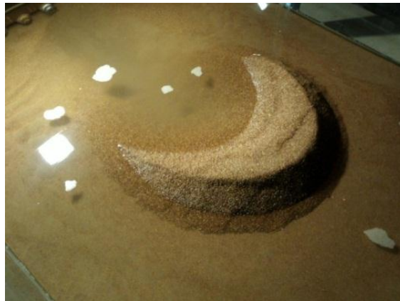
شکل ۲۰: تصویر الگوی آبشستگی در عمق استغراق ۳۰
