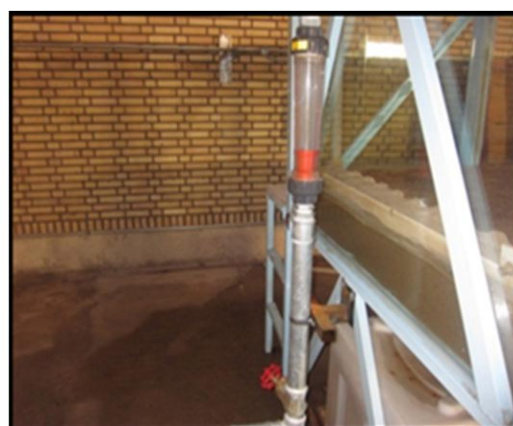
شکل ۱۱: دبی‌سنج روتامتر و شیر کنترل دبی جریان ورودی به فلوم
