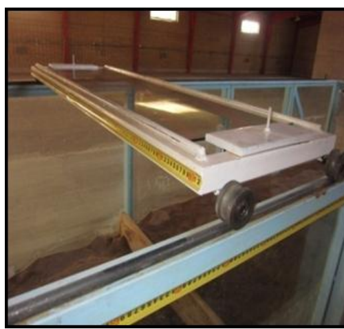
شکل ۵: تجهیزات ارایه دو بعدی جهت برداشت الگوی آبشستگی
