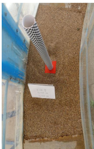
شکل ۶: محل تشکیل آبشستگی و رسوب‌گذاری در اطراف پایه با طوقه
