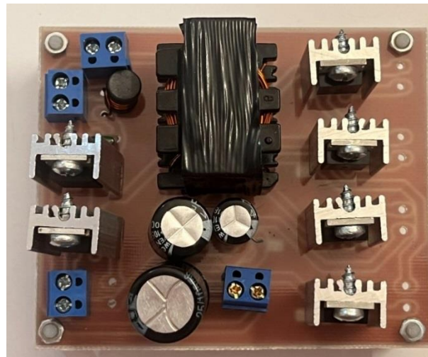
شکل (۱۱): نمونه آزمایشگاهی مبدل مورد مطالعه
