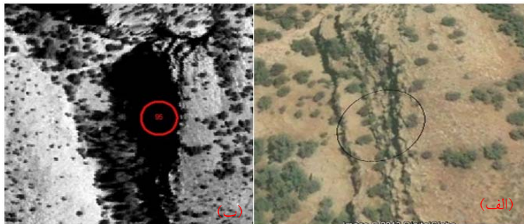
شکل ۳. مقایسه کیفیت دید برای تفسیر همزمان در قطعات نمونه بر روی تصاویر گوگل ارث (الف) و عکس‌های ارتوفوتوی قدیمی (ب). به علت وجود سایه در عکس‌های قدیمی، بعضی از قطعات نمونه قابل تفسیر نمی‌باشند.
