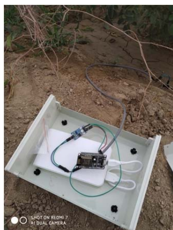
شکل ۳. جایگذاری حسگر رطوبت خاک و استفاده از ماژول
