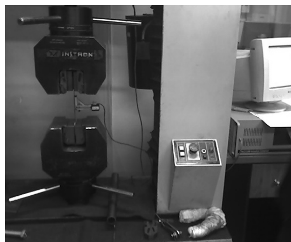
شکل (۷): ابزار آزمایش کشش
