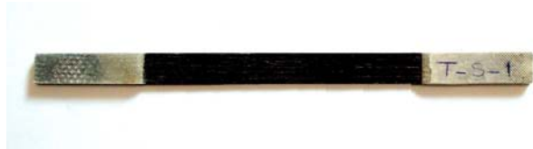
شکل (۴): نمونه‌های کششی ساخته شده
